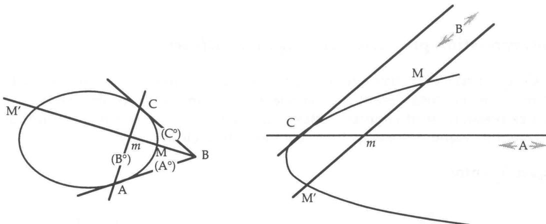
(29-2) Théorème : étant donnée une conique propre  $\Gamma$  tangente à la droite de l'infini en A, on considère un point à l'infini B distinct de A et l'on note C, le point de contact de la seconde tangente à  $\Gamma$ , issue de B. La droite (AC) est axe de symétrie oblique de  $\Gamma$  suivant la direction de (BC).
