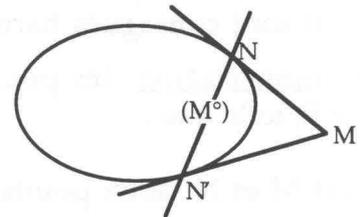
**Remarque** : par tout point du plan non situé sur  $\Gamma$ , il passe deux tangentes, réelles ou imaginaires conjuguées. On définit l'extérieur de la conique comme l'ensemble des points où ces tangentes sont réelles.
